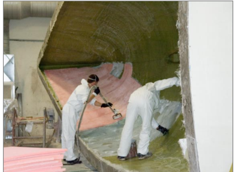
Indstøbning af Divinycell mellem glasfiberlagene. Skumpladerne rulles fast, så eventuelle luftlommer fjernes
