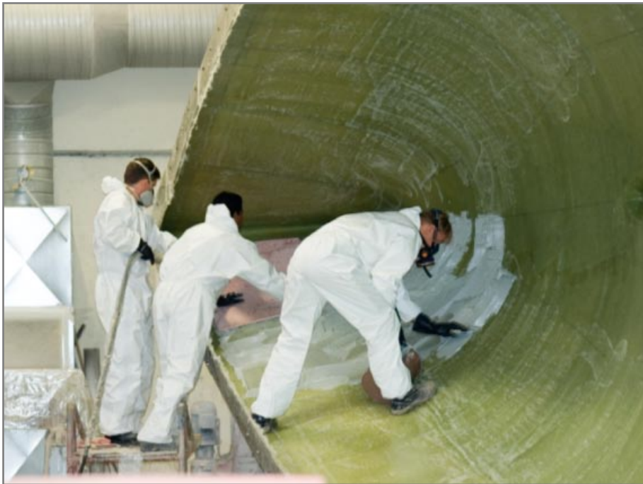
Indstøbning af Divinycell mellem glasfiberlagene.
