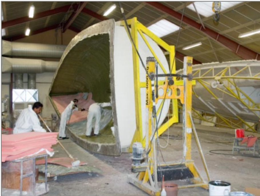
Indstøbning af Divinycell mellem glasfiberlagene. Glasfiberforstærket polyester med divinycell sandwich, bygget i håndoplæg.
