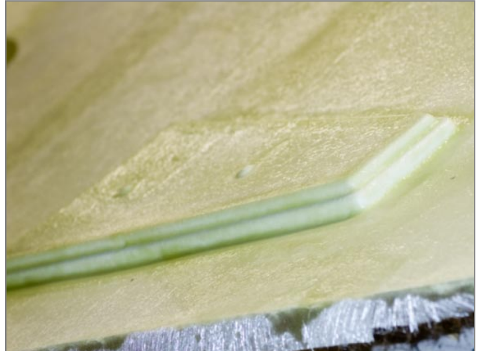
Støbning af dæk - Luge til ankerbrønd
