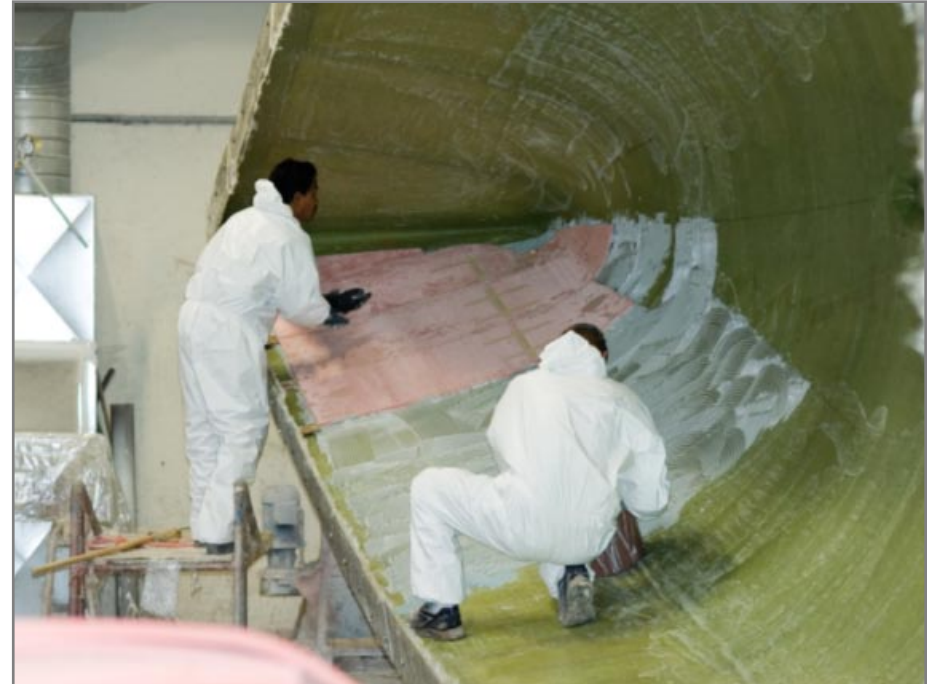
Indstøbning af Divinycell mellem glasfiberlagene.
