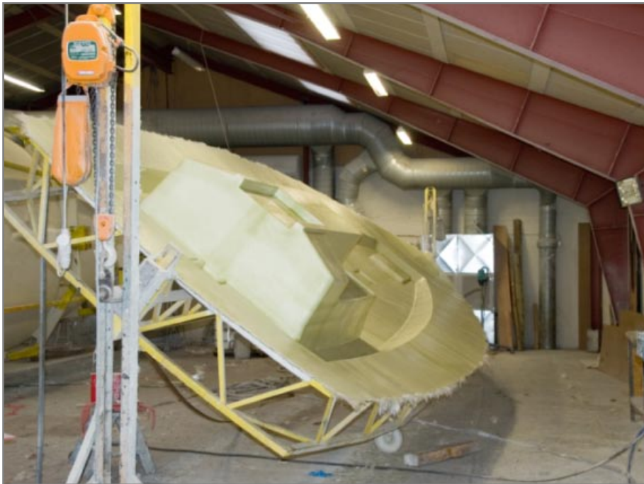
Støbning af dæk på Faurby 396 - Avalon - Byggenummer 11
